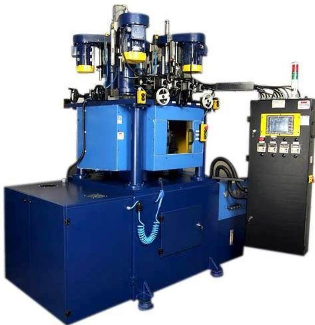
**Агрегатный станок** – это специальные полуавтоматические или автоматические станки, конструкция которых состоит из унифицированных узлов и механизмов, не связанных между собой единой кинематической схемой. Область применения данного оборудования охватывает группу предприятий с крупносерийным и массовым производством. Их основное назначение – это обработка деталей, имеющих объемные (коробчатые) формы.
